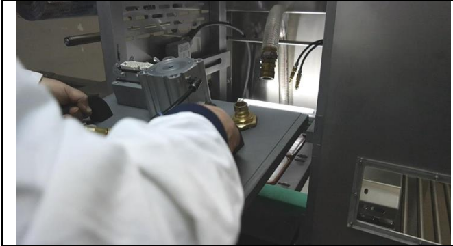
ÜST KAYNAK ÜNİTESİNİ KAYDIRARAK ÇIKARTIN
