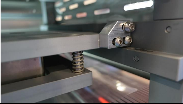
KAYNAK ÜNİTESİ SAĞ KİLİT VİDASINI SÖKÜN
